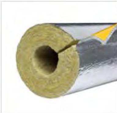
Konzentrische, maßgenaue Steinwolle-Rohrschale mit einer gitternetzverstärkten Aluminiumfolie kaschiert, selbstklebende Überlappung, einseitig geschlitzt. Rohrleitungen für Heizungs- und Brauchwasseranlagen, Solarleitungen, Rohrleitungen in betriebstechnischen Anlagen, Rohrabschottungen der Feuerwiderstandsklasse R-30 bis R-90.
